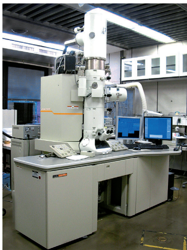
Abbildung 2. JEM-2100F, ein TEM-Apparat, der für den Film in Abbildung 1 eingesetzt wurde und in vielen Institutionen weltweit verfügbar ist. Wenn nötig wurde ein JEM-2100FC-Gerät verwendet, das mit einem Aberrationskorrektor für die Objektivlinse und einem Heliumtemperatur-Probenhalter ausgestattet war.
