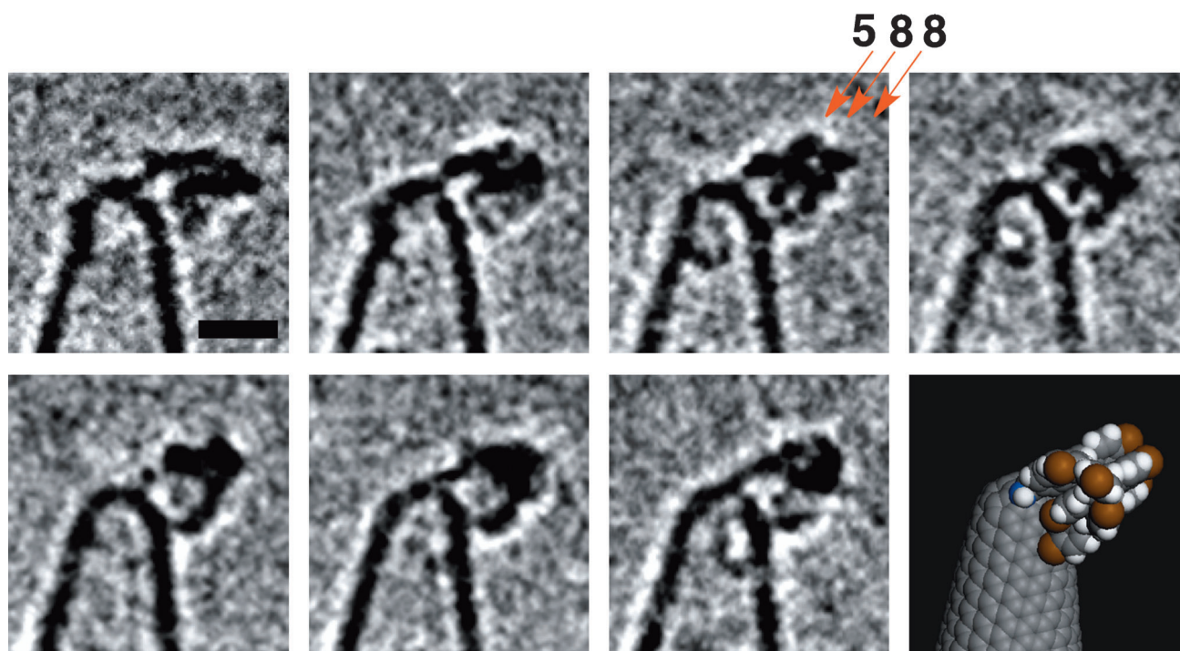
Abbildung 12. Termolekularer [5+8]-Cluster auf einem CNH bestehend aus einem Templat Y' und zwei Molekülen Y, sowie das Molekülmodell einer plausiblen Clusterstruktur. Die Bilder wurden in Zeitintervallen von 8.4 s ( E=120 kV) aufgenommen. Die gesamte Elektronendosis während der Beobachtungszeit betrug 9.0 \times 10^5 Elektronen \text{nm}^{-2} . Der Cluster bildete sich während der Umkristallisation von 8 über 5 und wurde durch Filtration für die TEM-Analyse wiedergewonnen. Der angegebene Balken entspricht 1 nm. Der Film und vergrößerte Bilder befinden sich in Film S10 und Abbildung S10. (Aus Lit. [14].)
